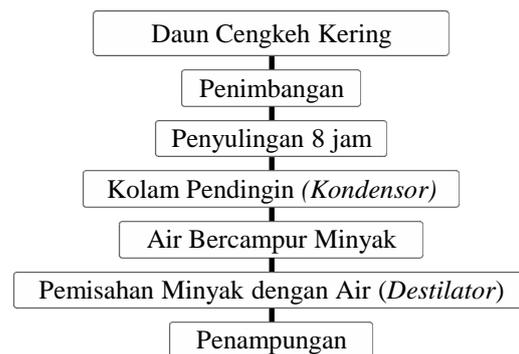
Gambar 1. Alur Proses Produksi Minyak Daun Cengkeh, 2014.
