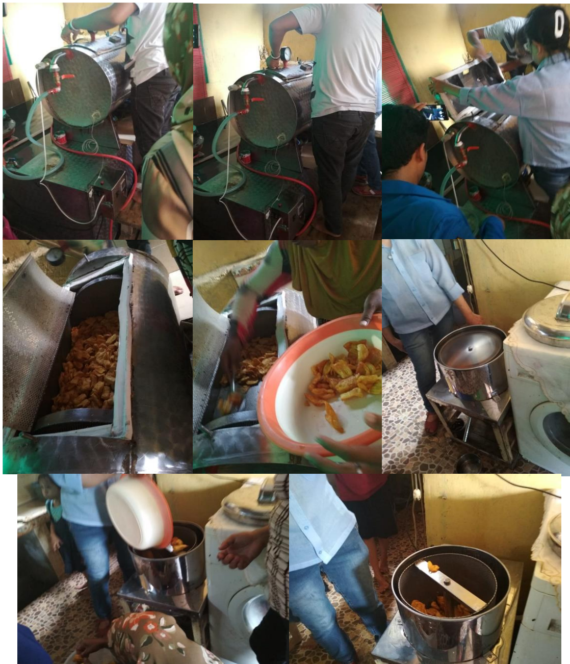
Gambar 4. Proses penggorengan, pengeringan dan penirisan kripik nangka
